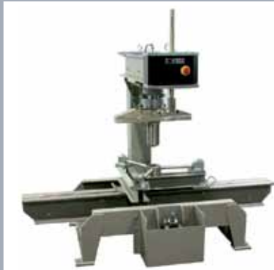
Marco de flexión en la configuración de ensaye conforme con ASTM C1550, con máquina de comando servo-controlada.
