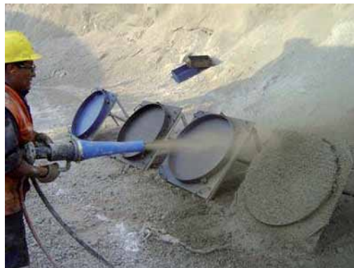
Moldeo de los paneles para el ensayo ASTM C1550.
