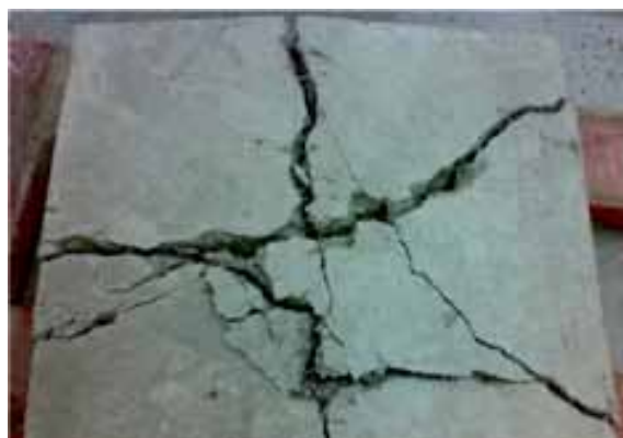
Imágenes del ensayo sobre placas cuadradas según el método EN 14488-5.
